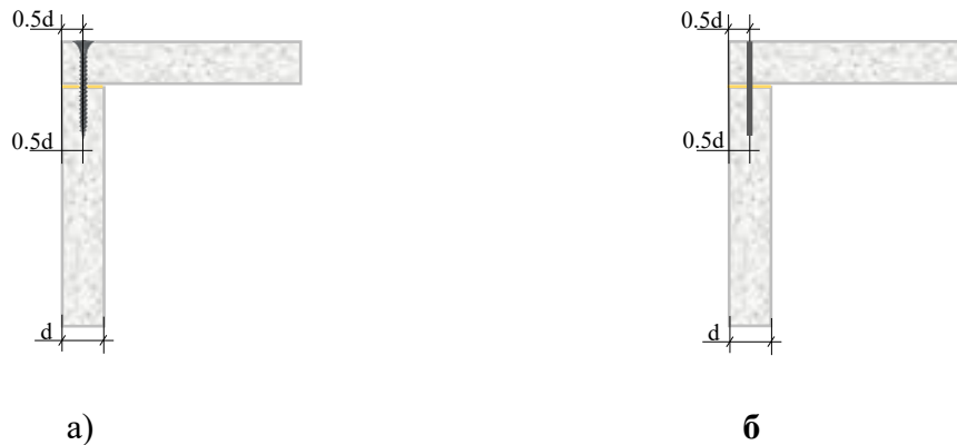
Рис. 2. Схема кріплення плит за допомогою саморізів (а) та скоб (б).
